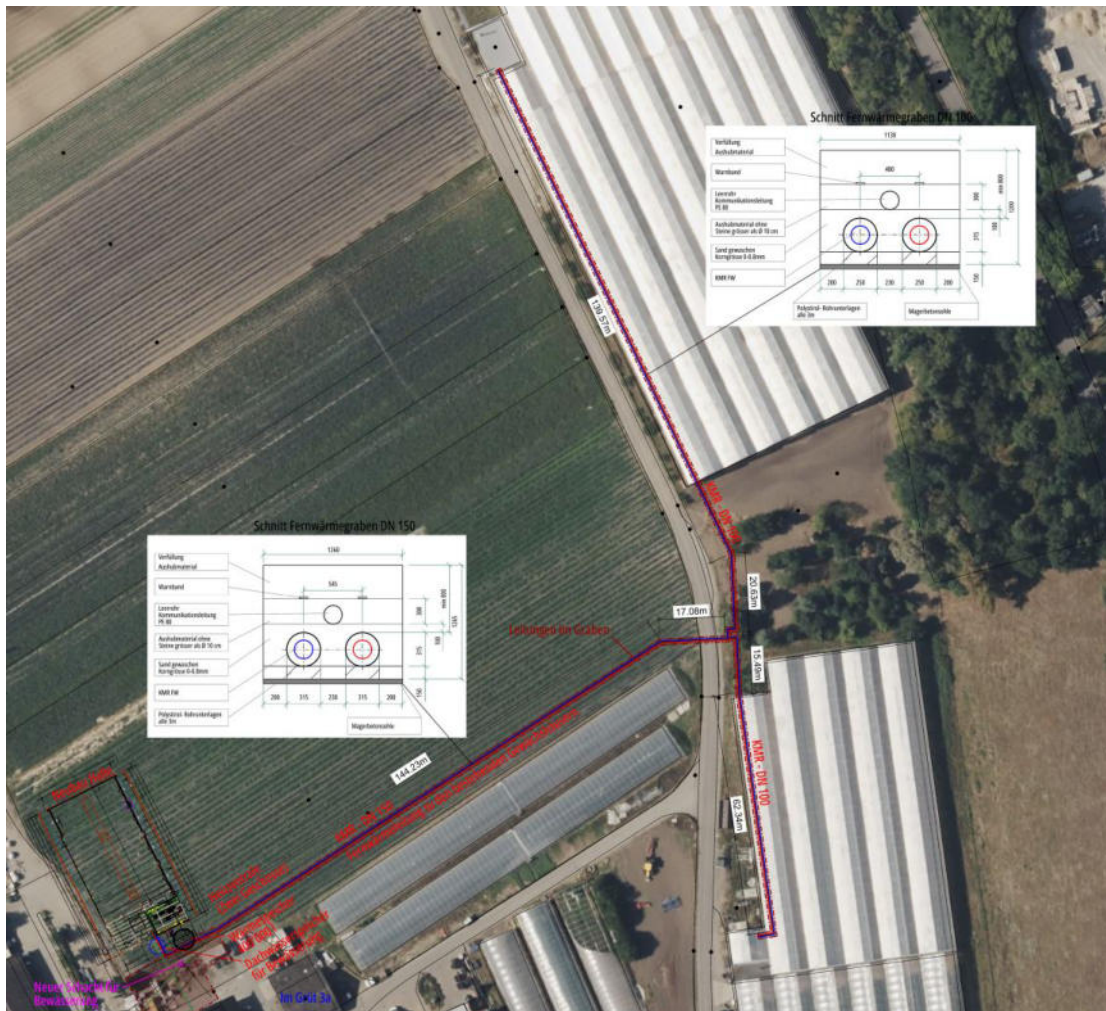
Abbildung 5 Ausschnitt aus dem Fernwärmeplan mit den beiden Gewächshäusern
