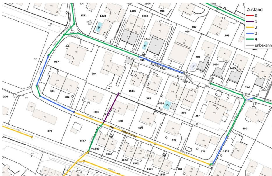
Abbildung: Ausschnitt Zustandsbeurteilung öffentliche Kanalisation
