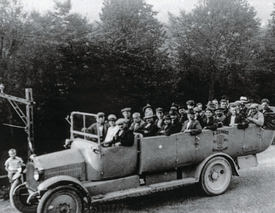
Alfred Zehnder fährt mit seinem Saurer-Autobus (Modell «Badwanne») Birmenstorfer Arbeiter in die Badener Industrie. Das Fahrzeug mit Vollgummireifen und Kettenantrieb hatte er 1926 als Occasion gekauft und 1928 mit einem abklappbaren Verdeck ergänzt. Eine Postautoverbindung nach Baden bestand erst seit 1946, weshalb als Alternative zu Fussmarsch oder Velofahrt private Arbeitertransporte in die Badener Fabriken durchgeführt wurden. Fotografie um 1928/29. (Sammlung und Archiv Birmenstorf)
